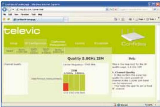
Der Access Point des drahtlosen Confidea® Systems verfügt über einen eingebauten Webserver. Für einfache Installationen ist daher keine zusätzliche Software erforderlich. Über einen gängigen Internetbrowser kann auf den Server zugegriffen werden. Hierdurch werden Kosten reduziert und die Bedienung stark vereinfacht.
