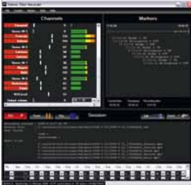
Die TReX Aufnahmesoftware bietet alles, was Sie zur Audioaufnahme Ihrer Konferenz benötigen, einschließlich der übersetzten Sprachkanäle. Die Software läuft auf einem normalen PC und kann in ihrer Grundkonfiguration 2 Audiokanäle gleichzeitig aufnehmen. Durch zusätzliche Lizenzen und der entsprechenden Soundkarte, können bis zu 20 Sprachen gleichzeitig aufgenommen werden.
